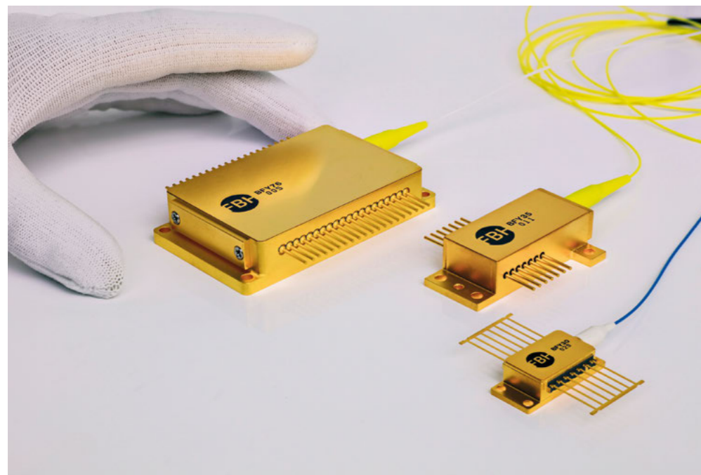
➊ Different pulsed diode laser modules for medical diagnostics and treatment Verschiedene gepulste Diodenlasermodule für die medizinische Diagnostik und Behandlung.
